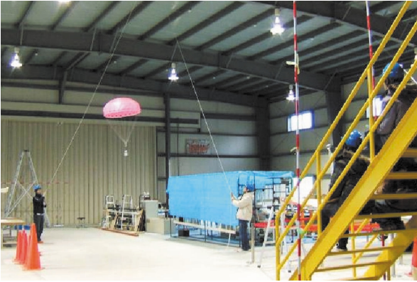
写真3 火星探査機のためのパラシュート降下試験
