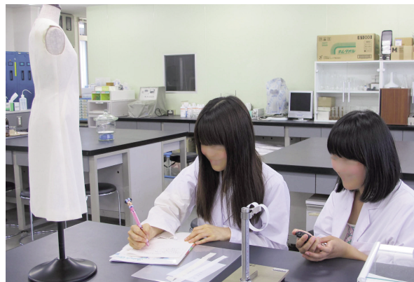
図4 ハートループ法で剛軟度測定
