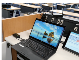
実習室に導入されたワイヤレスプレゼンテーションシステム PressIT。PCに挿してボタンを押すだけで画面送信が可能
