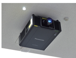
大講義室の3チップDLP®レーザープロジェクター PT-RZ21KJ
